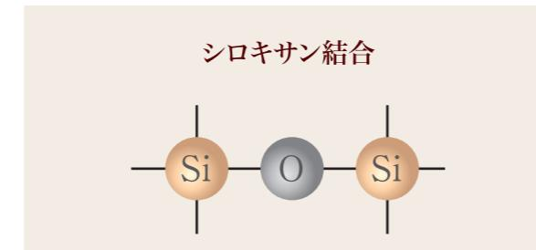
紫外線等の劣化要因に強いシロキサン結合が多く、塗膜の劣化を抑制。
