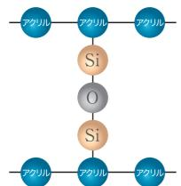
紫外線により劣化しやすい結合箇所が多く、塗膜が劣化しやすくなる。
