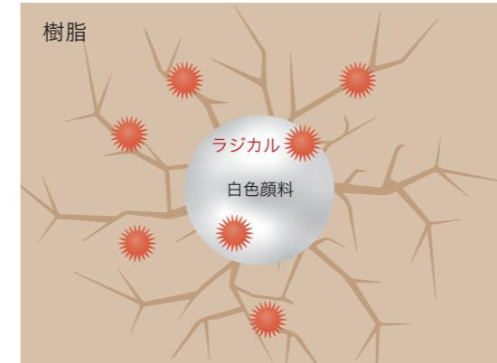
発生したラジカルにより、塗膜が破壊。
